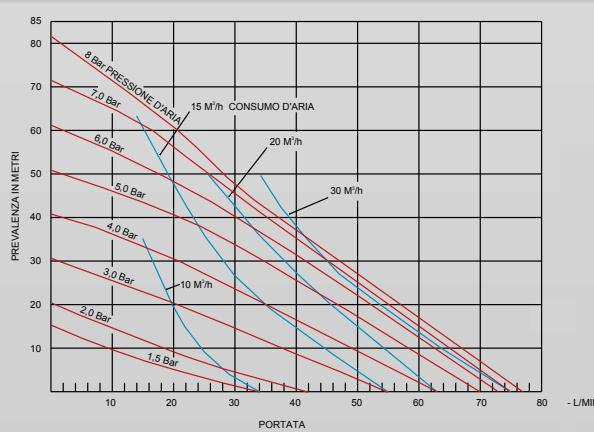
**Nota:** La curva caratteristica è stata determinata alle seguenti condizioni: aspirazione sotto battente, pompaggio di acqua pulita attraverso un misuratore di flusso elettronico calibrato con smorzatore di pulsazioni e silenziatore.
